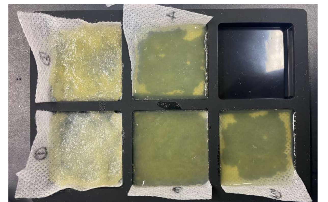
図. グリセリン量の違いによる皮革シートの質感の把握のための実験(着色前)
