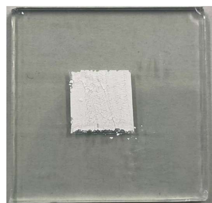
スキージ法で塗布したTiO 2 電極
